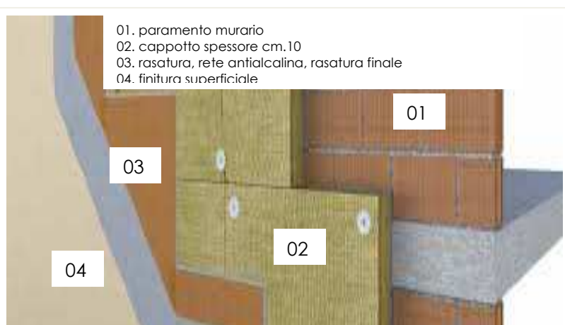
Fig. 12- Es. di isolamenti termoacustici perimetrali
